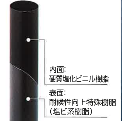
内面: 硬質塩化ビニル樹脂 表面: 耐候性向上特殊樹脂(塩ビ系樹脂) ※たてといには亜鉛処理スチール芯は入っておりません。
